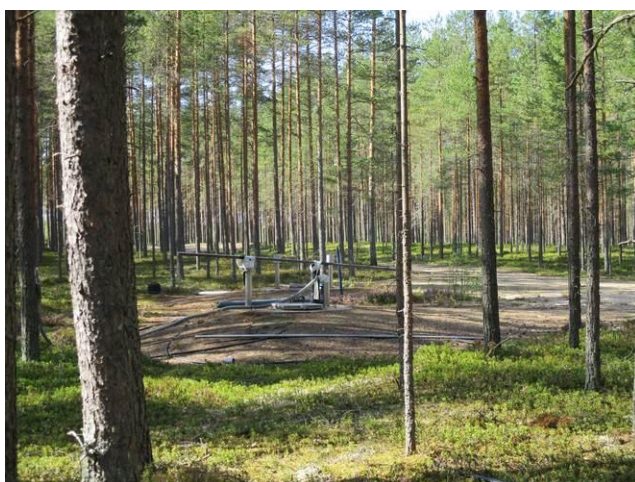
Kuva 8. Pohjaveden mittauspiste suunnitellun vedenottamon Nutturakangas 3 kohdalla.
