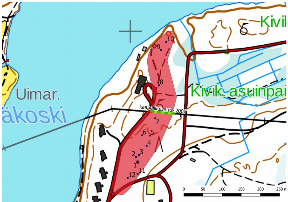
Pyhäkoski 2, aluerajaus ja rakenteet 1-12, vuonna 2007 kaivettu ja valvottu kaapelilinja sijaitsee voimajohtokäytävän pohjoisreunalla. Kohdekoordinaatit on muutettu rakenteen 1 kohdalle.
